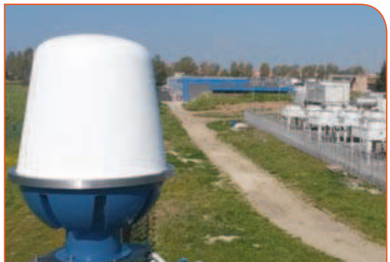
■ Navtech Radar: sicurezza su aree molto ampie in qualsiasi condizione ambientale e rilevazione di persone fino a 1000m di raggio e di veicoli fino a 2000m di raggio
